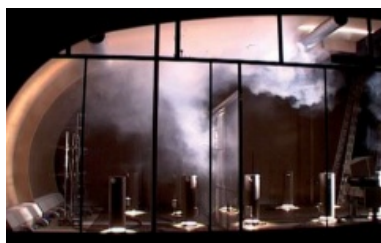
Áramlásvizsgálat: modellkísérlet a TROX kutatási és fejlesztési laboratóriumában
